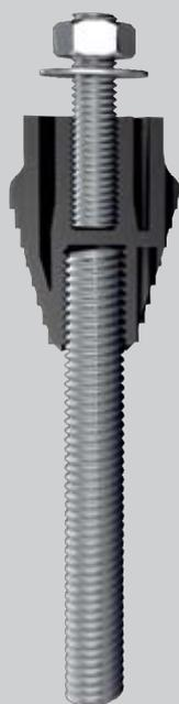
**Elemento di fissaggio con resina chimica termicamente isolato. Cono autofilettante: in fase di montaggio ricava direttamente la propria sede attraverso l'intonaco e l'isolamento.**
